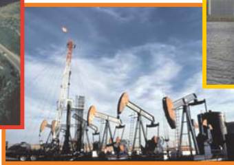
Appareil de forage et chevalets de pompage
