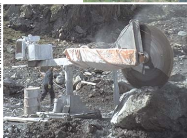
Scie diamantée découpant un bloc de jade
