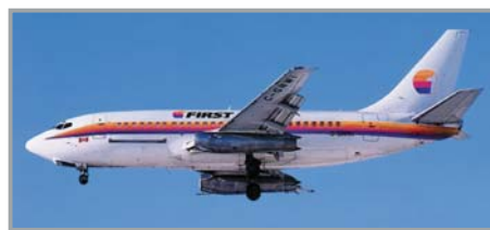
Presque 60 km de fils de cuivre parcourent un Boeing 737
