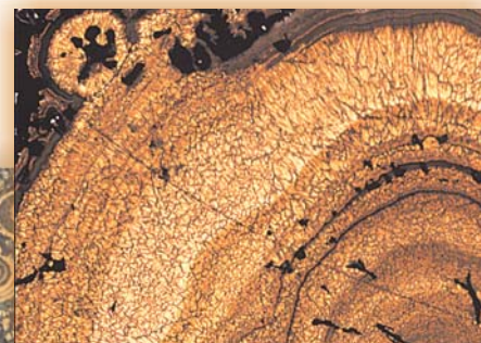
Plaque mince d'une colonne de sphalérite montrant des anneaux de croissance et des cristaux
